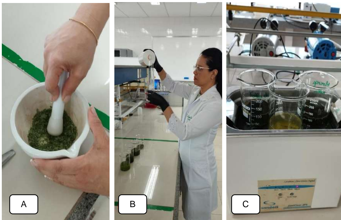
Figura 07 – Etapas para obtenção do extrato etanólico bruto das amostras de Plantas Alimentícias não Convencionais. Material triturado (A), adição de álcool (B) e amostras do ultrassom (C) - Laboratório de Farmacognosia - UNIVASF, 2022.
