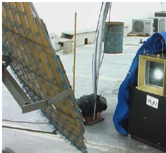
Figura 2. Concentrador solar projetando foco em um forno (DIB, 2009).
