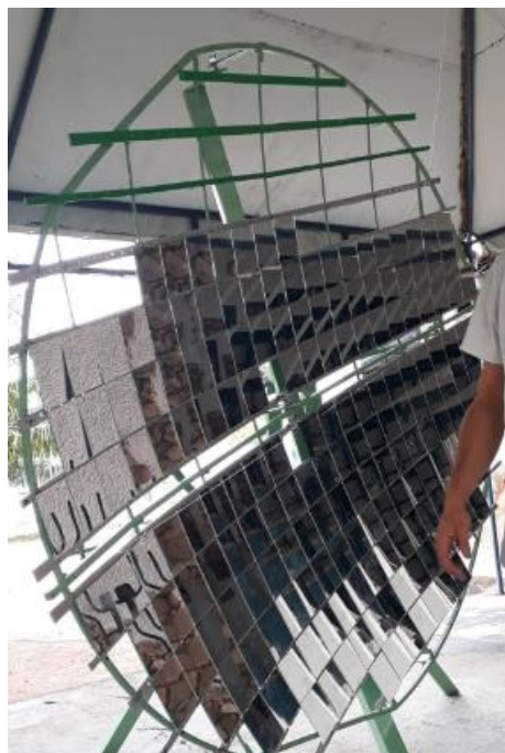
Figura 26. Processo final de fabricação do concentrador solar: instalação do material reflexivo.
