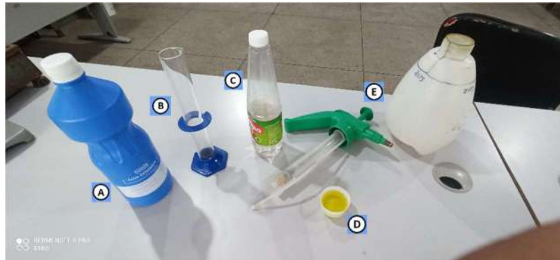
Figura 20 - Água oxigenada (A), proveta de vidro (B), vinagre (C), detergente neutro (D), pulverizador manual (E)
