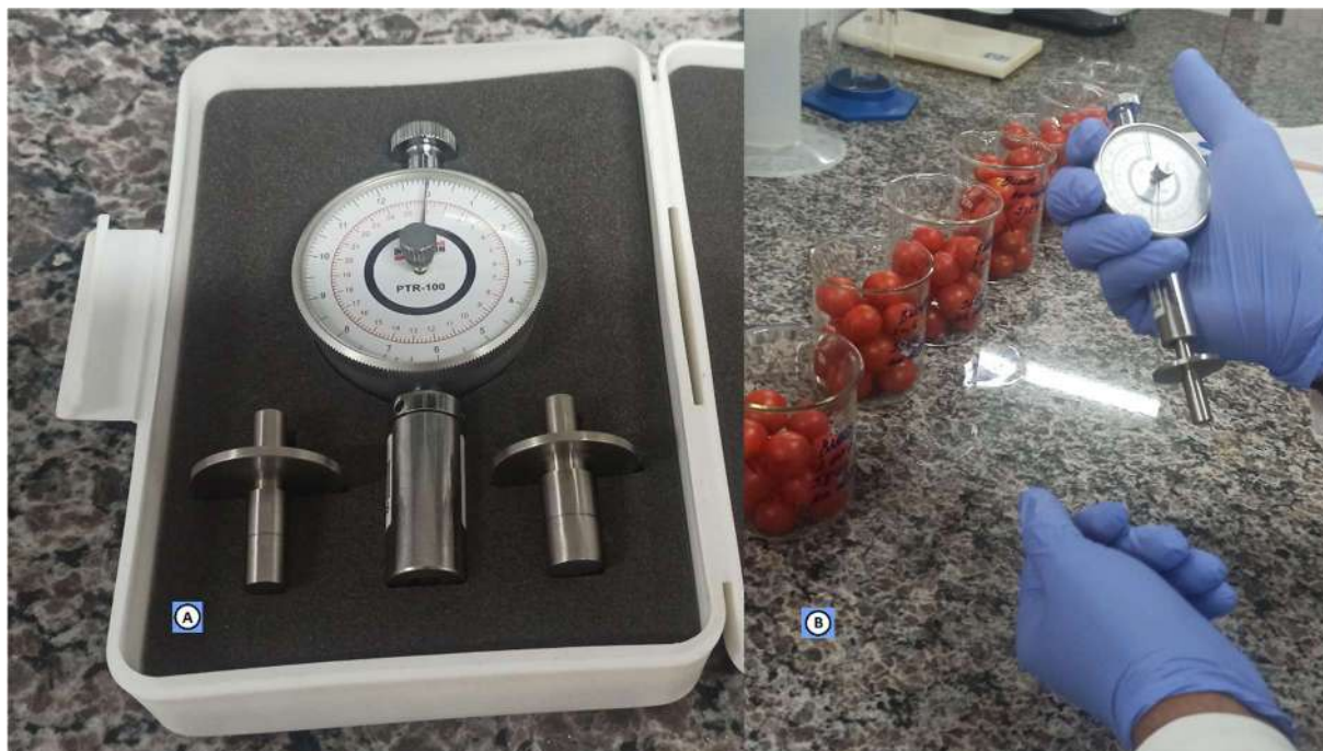
Figura 29 - Análise de dureza e ponto de colheita de frutos. A - Penetrômetro: instrumento analógico para. B – Detalhe da forma de utilização.
