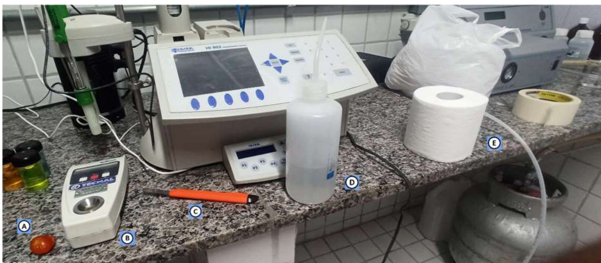
Figura 28 - Obtenção do teor de sólidos solúveis totais (SST). A - Fruto, B - Refratômetro, C - Estilete, D - Água destilada, E - Papel higiênico.
