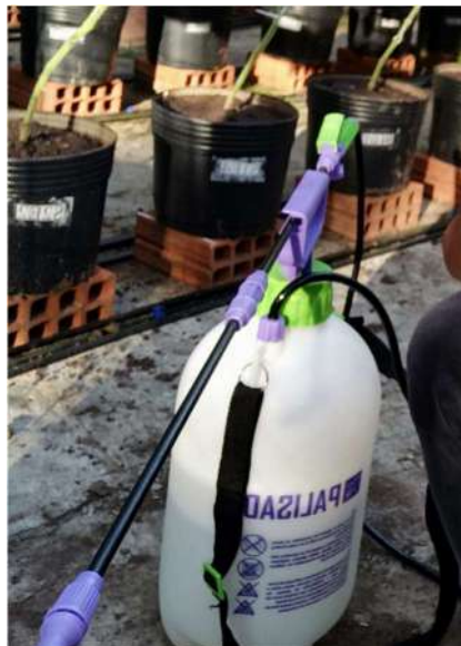
Figura 21 - Pulverizador manual de 5 litros de pressão com válvula de segurança e bico ajustável.
