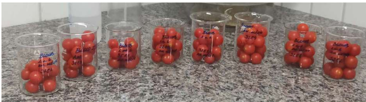
Figura 31 - Frutas escolhidas para obtenção dos sólidos solúveis totais (SST), análise de dureza, pH e acidez total titulável (ATT).
