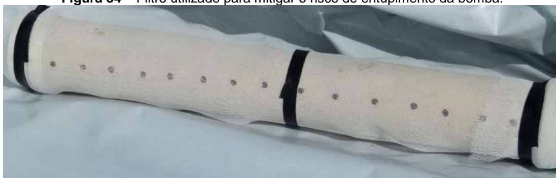
Figura 34 – Filtro utilizado para mitigar o risco de entupimento da bomba.
